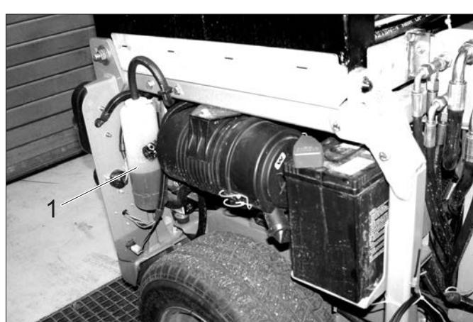
1 Expanzní nádoba chladicí kapaliny
