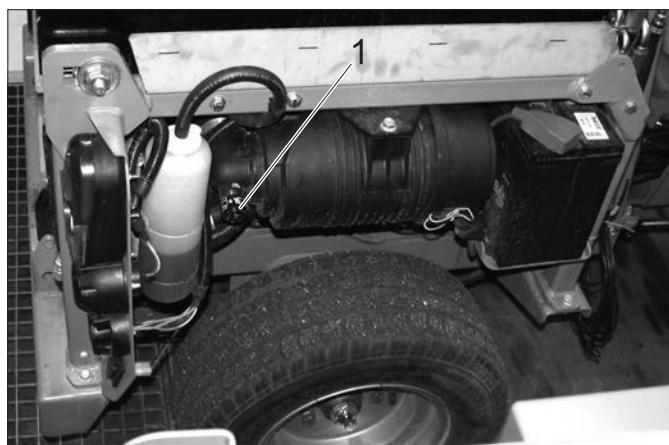
1 indikátor výměny vzduchového filtru
