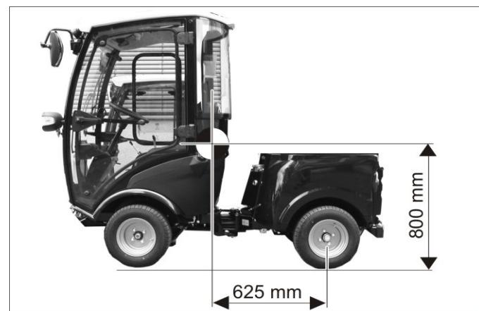
Poloha těžiště bez nasazeného přídavného zařízení.
