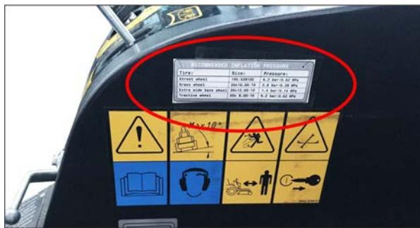
Şekil: Sürücü kabininde tavsiye edilen lastik basınçlarının yazdığı etiket
