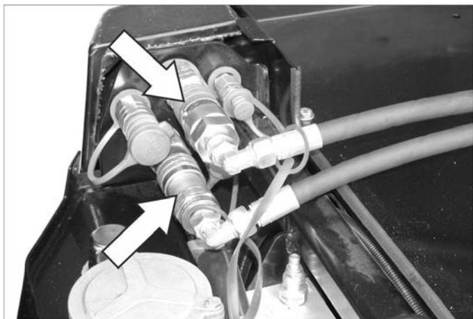
→ Skinite zaštitne kapice sa hidrauličkih spojnica pa spojite hidraulička creva sa odgovarajućim spojnicama.
