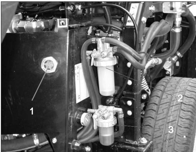
1 Olejoznak hydraulického oleje
