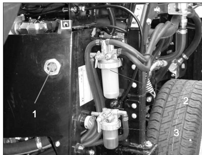
1 Kontrolno okno za proveru hidrauličkog ulja
