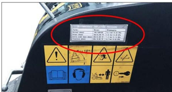
Ábra: Címke a vezetőfülkében a keréknyomás ajánlott értékeivel
