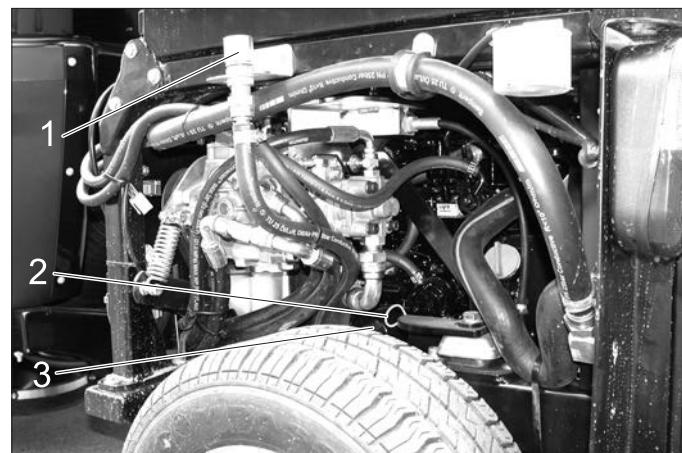
1 Víko otvoru pro doplnění oleje (motor)
