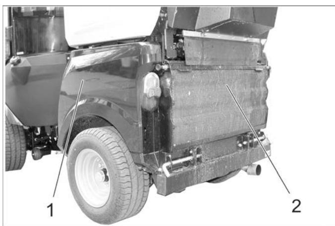
1 Bočna oplata motora
